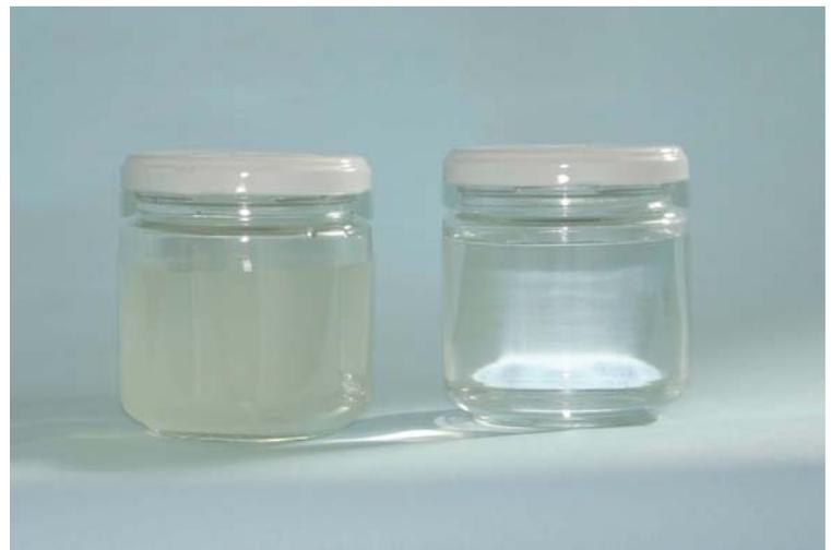
左側 油分除去フィルター通過前 右側 油分除去フィルター通過後
